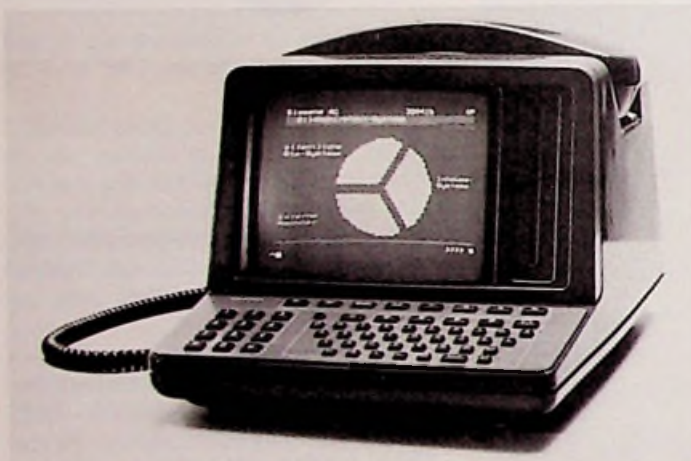
Bild 5: Bildschirmtelefon „Bitel“ als Btx-Dialoggerät (Siemens-Pressbild)
