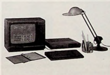
Bild 2: Bildschirmtext-Anlage für den CEPT-Standard (Philips-Pressbild)
