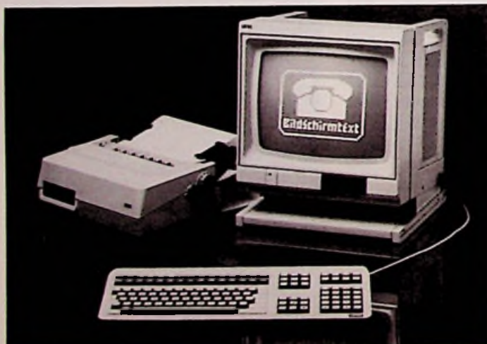
Bild 8: Bildschirmtext-Terminal mit Editiertastatur (Loewe-Pressbild)
