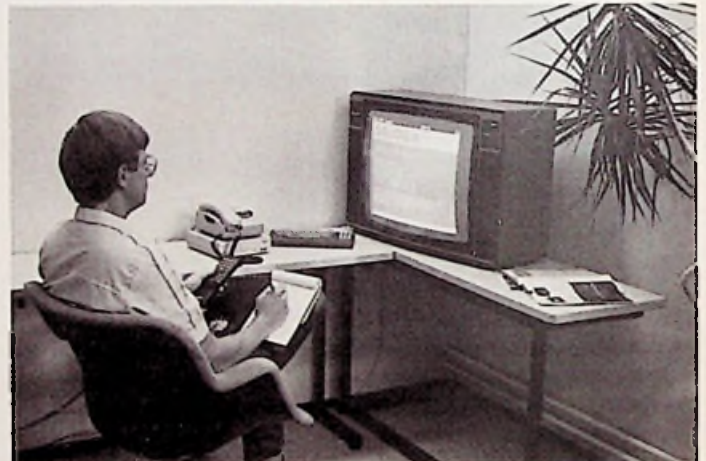
Bild 6: Bildschirmdialoggerät für den CEPT- als auch den Prestelstandard (Salora-Pressbild)
