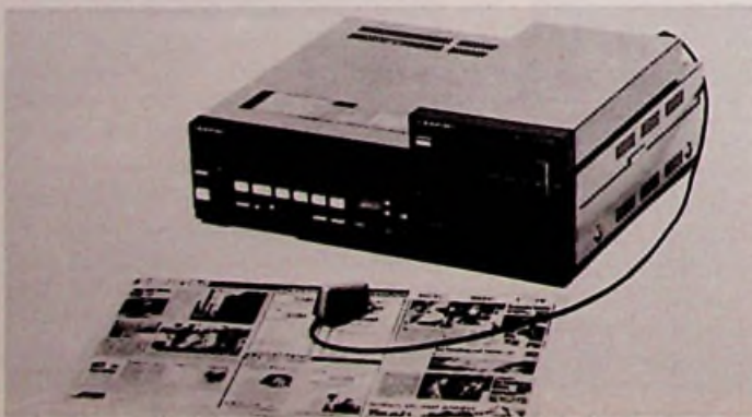
Bild 1: ZPS-Decoder mit IR-Bedienung
